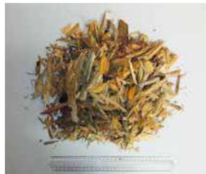
Broyeur sur plateforme, modalité de broyage 105 x 150 mm.
