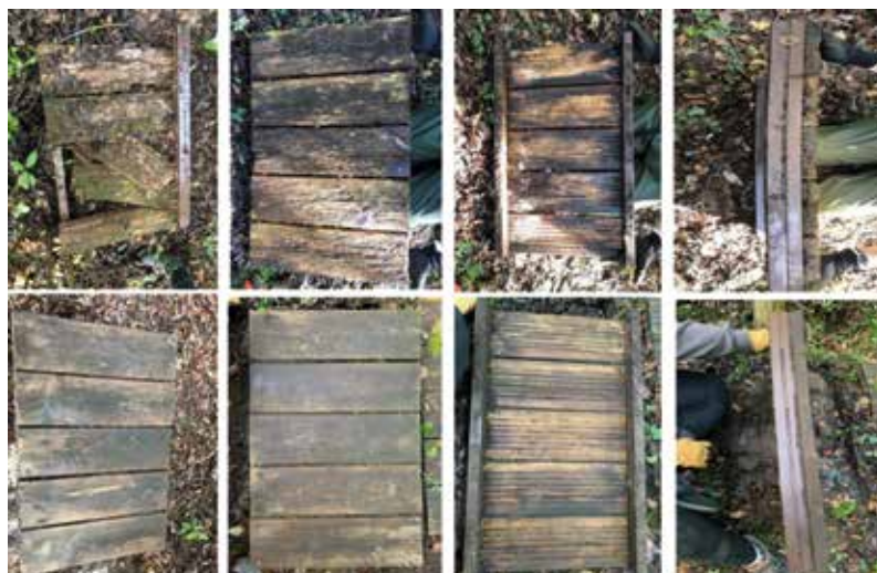
▲ Platelages témoins de pin maritime après 10 ans d'exposition sur le terrain en contact direct avec le sol. En haut, les platelages non traités : les dommages résultent essentiellement des dégradations fongiques ; en bas, les platelages traités pour la classe d'emploi 4, restés en bon état.
