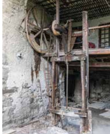
▲ L'ancienne scie hydraulique de L'Argentière-la-Bessée (05)
