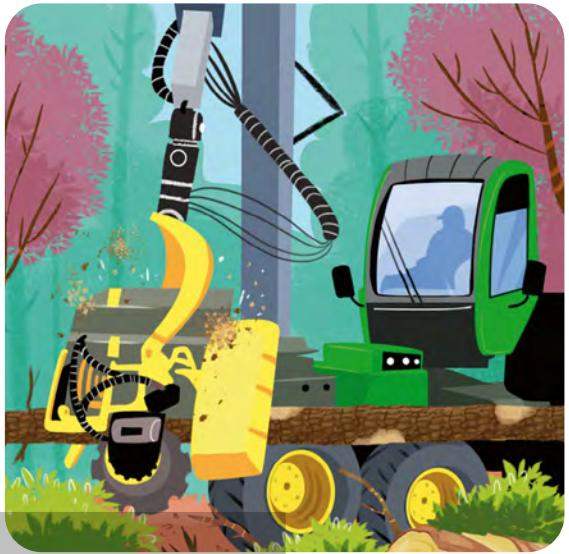
Grâce à l'ordinateur de bord, cette conductrice programme l'abatteuse pour enlever les branches du tronc et le découper en morceaux de différentes tailles : des billons.
