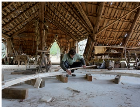
Assemblage d'une roue pour la cage à écureuil sur le plancher d'épures.
