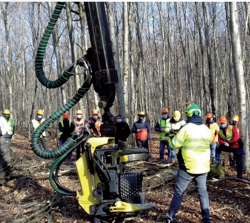
▲ Présentation des caractéristiques de la nouvelle tête John Deere H212 par Thomas Richard (John Deere) : « L'emploi d'une tête H212 se justifie lorsque l'on traite 90 % de tiges de 25 cm et moins. »
