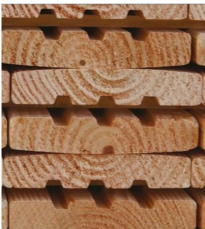
La lame de platelage est un produit de technologie, étudié de longue date pour le bombé, les rainures et le sens des cernes.
