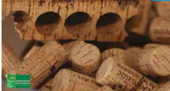
Le tubage des bouchons est effectué dans l'épaisseur de l'écorce.
