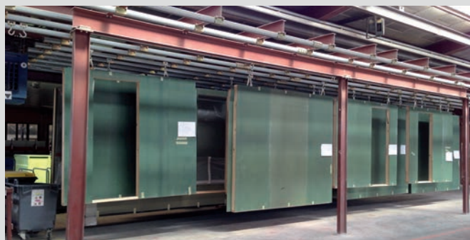
La chaîne verticale de fabrication permet la pose des menuiseries et du bardage.
