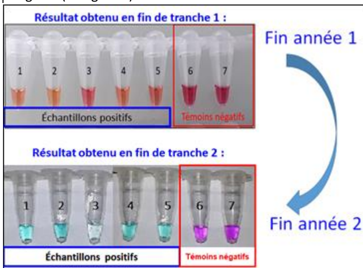
Figure 1 : Illustration d'un résultat type d'analyse LAMP visible à l'œil nu avant (année 1) et après (année 2) l'optimisation de la lecture directe des résultats. Les tubes présentés contiennent un réactif dont la coloration indique la présence ou absence du nématode. Le passage du colorant Jaune/Rouge en année 1 au colorant Bleu/Violet optimisé en année 2 permet de distinguer plus clairement les résultats faiblement positifs (tube 3, faible trace de nématode) d'avec les négatifs (tubes 6 et 7, absence de nématode).
