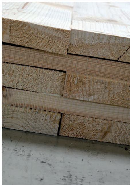
◀ Chant d'un panneau contrecollé-croisé (CLT, Cross Laminated Timber ).
