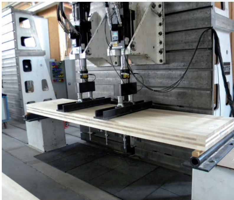
▲ Machine d'essais pour les panneaux massifs contrecollés de peuplier.
