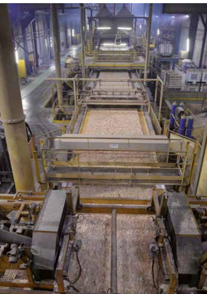
◀ Ligne de production en continu pour l'OSB.
