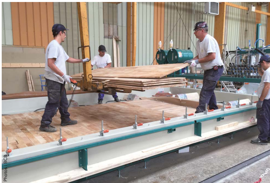
◀ Fabrication du CLT en chêne : composition du pli extérieur.
