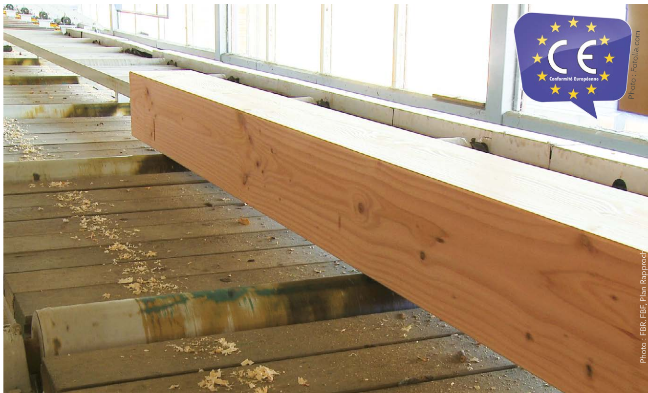
▲ La présence du BNBA à la commission de normalisation européenne a permis d'imposer le marquage CE des bois de structure par paquets, plutôt que par éléments.
