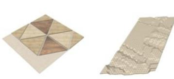
*Procédé de fabrication : Des couches de pliage de bois de 1mm sont taillées en triangle puis collées sur une tissu textile en fibre de bois*
